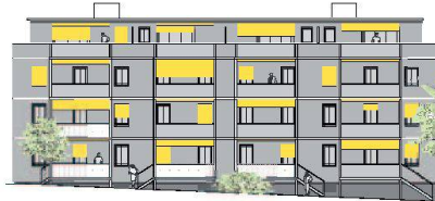
La façade nord après surélévation et isolation en bois.
