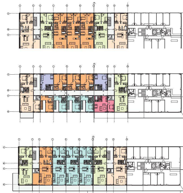
De bas en haut: plan des 1 er et 4 e étages, 2 e et 5 e étages avec rue intérieure, 3 e et 6 e étages.
