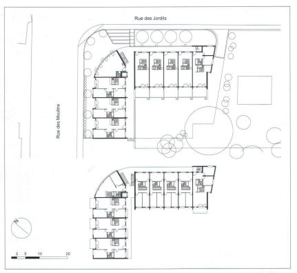
Plans du rez -de-chaussée et de l'étage
