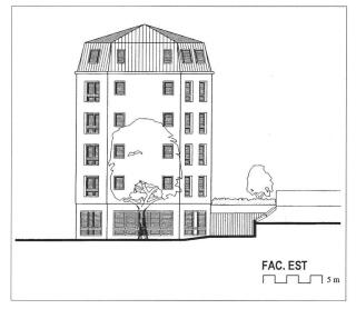
«Atelier d'Ouchy, architectes sa» a conduit le projet jusqu'à son terme prévu pour le printemps 1998. La façade sud (en tête de page) montre le parti-pris de l'architecte G. Leresche d'une construction à pans coupés. On retrouve naturellement cette constante dans les différents plans de coupe, d'étages et de la façade Est tel qu'ils sont reproduits dans cette page. L'échelle qui accompagne ces dessins en facilite l'interprétation technique.
