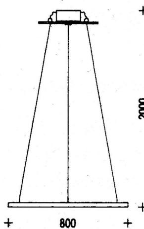
TANTRA est un système d'éclairage qui peut être orienté à volonté dans des angles quelconques dans la salle. Ceci est rendu possible par moyen de la poulie de guidage. La surface du système total, y compris les éléments lumineux, se présente en laiton nickelé mat, brossé et corps isolant noir ou en métal poli nickelé noir. Pour les modèles différents et leurs fonctions, nous vous prions de bien vouloir vous référer à la liste des prix de vente.
