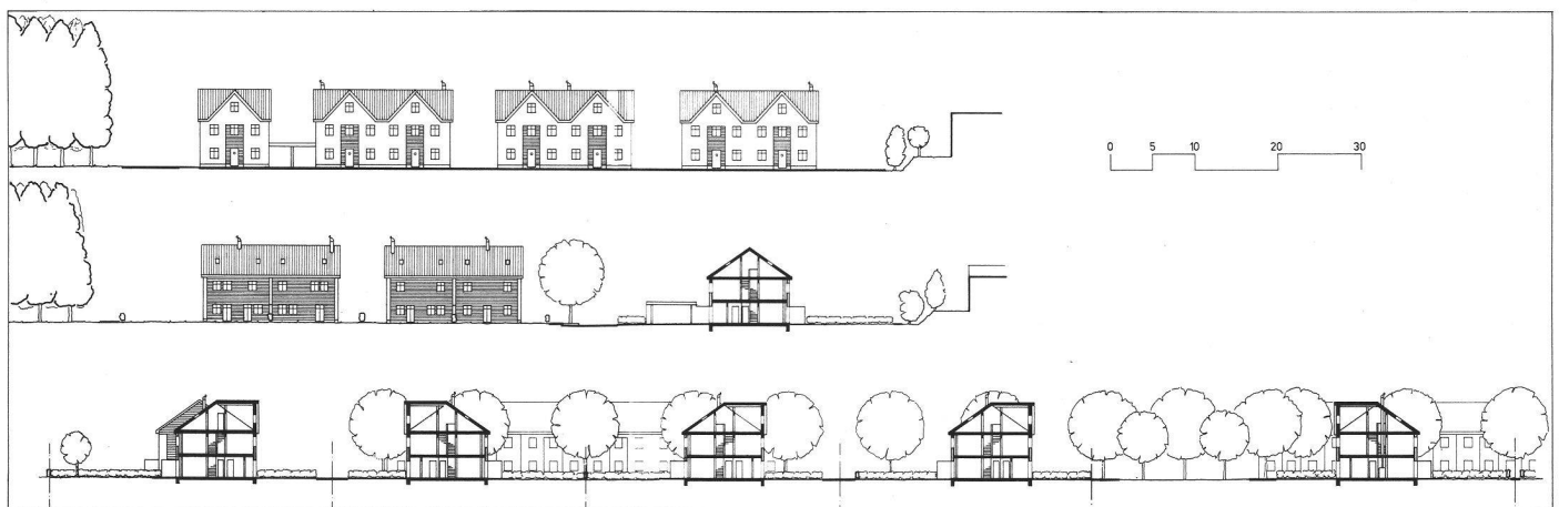
Fig. 9 — Maisons jumelles: élévation sur rue et sur jardins; coupe longitudinale à travers la première étape.
