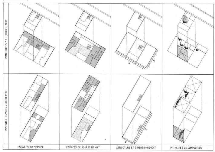
ponctuelle dans les deux cas, permettant, selon les principes corbuséens, l'établissement du «plan libre» et une «variété infinie de plans».
