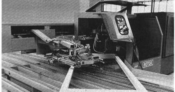
Nouvelle usine EgoKiefer à Villeneuve: machine automatique en continu pour le nettoyage de soudures d'angles, intégrée dans l'unité de production la plus moderne en Suisse, pour la construction de fenêtres en matière plastique.
