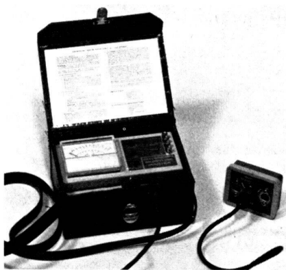
L'appareil pratique Sovereign pour la mesure de l'humidité est livré prêt à l'emploi.
