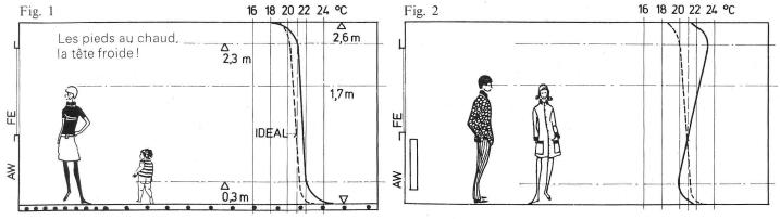
grâce au chauffage par le sol, la température diminue progressivement en montant du sol au plafond (fig. 2); avec un chauffage par radiateurs c'est l'inverse. En effet, l'air est chauffé par la température élevée de la surface des radiateurs et monte au plafond. De ce fait on assiste à une forte concentration de chaleur sous le plafond (fig. 1).
