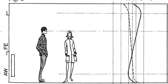
grâce au chauffage par le sol, la température diminue progressivement en montant du sol au plafond (fig. 2); avec un chauffage par radiateurs c'est l'inverse. En effet, l'air est chauffé par la température élevée de la surface des radiateurs et monte au plafond. De ce fait on assiste à une forte concentration de chaleur sous le plafond (fig. 1).
