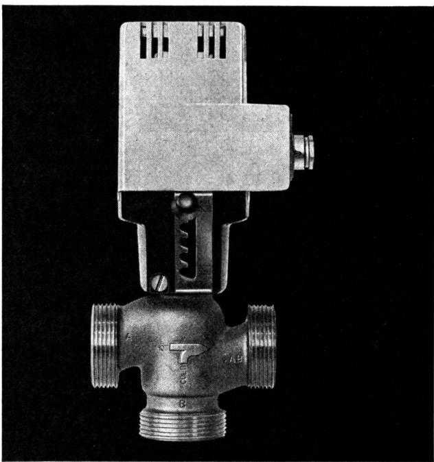
**Le système Sauter 10 a été spécialement développé pour des installations de chauffage à circulation forcée et possède les qualités suivantes: Prix avantageux grâce au nouveau système de commande motrice, allure de régulation continue à action proportionnelle, installation et entretien faciles, marche silencieuse et aucune surveillance pendant le service.**
