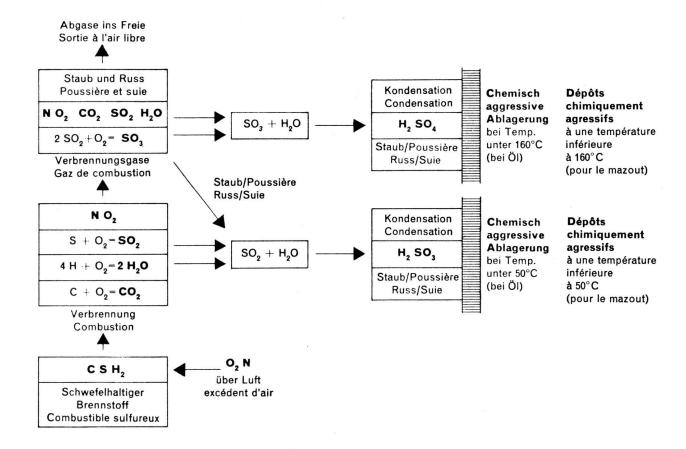
donner à la cheminée et à y maintenir la température requise. Pendant que les brûleurs fonctionnent, la température est constamment inférieure à celle du point de rosée de l'acide sulfurique. Les parois internes de la cheminée deviennent humides et les particules de suie et de saleté contenues dans les gaz de fumée adhèrent aux parois.
