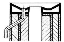
Couvercle de cheminée avec collecteur et tuyau d'écoulement.
