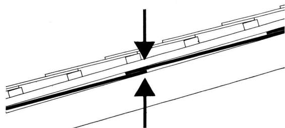
Le maître couvreur recommande la soustoiture comme un élément nécessaire du toit. Les plaques d'amiante-ciment marque «ETERNIT» et «GEA» en augmentent le pouvoir isolant. Elles forment une couverture étanche aux poussières, à la pluie, à la neige et à l'eau de fonte de celle-ci. Incombustibles, elles diminuent le danger d'incendie. La pose de la soustoiture «ETERNIT» ou «GEA» est simple et rapide. Eternit SA 8867 Niederurnen et 1530 Payerne
