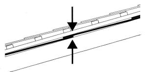
Le maître couvreur recommande la soustoiture comme un élément nécessaire du toit. Les plaques d'amiante-ciment marque «ETERNIT» et «GEA» en augmentent le pouvoir isolant. Elles forment une couverture étanche aux poussières, à la pluie, à la neige et à l'eau de fonte de celle-ci. Incombustibles, elles diminuent le danger d'incendie. La pose de la soustoiture «ETERNIT» ou «GEA» est simple et rapide. Eternit SA 8867 Niederurnen et 1530 Payerne
