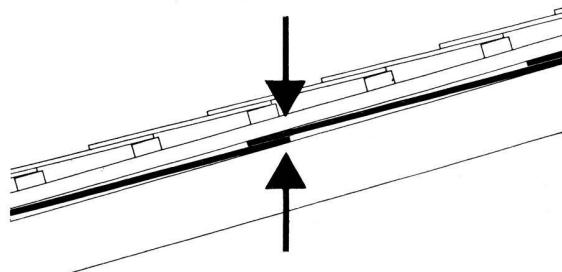
Le maître couvreur recommande la soustoiture comme un élément nécessaire du toit. Les plaques d'amiante-ciment marque «ETERNIT» et «GEA» en augmentent le pouvoir isolant. Elles forment une couverture étanche aux poussières, à la pluie, à la neige et à l'eau de fonte de celle-ci. Incombustibles, elles diminuent le danger d'incendie. La pose de la soustoiture «ETERNIT» ou «GEA» est simple et rapide. Eternit SA 8867 Niederurnen et 1530 Payerne
