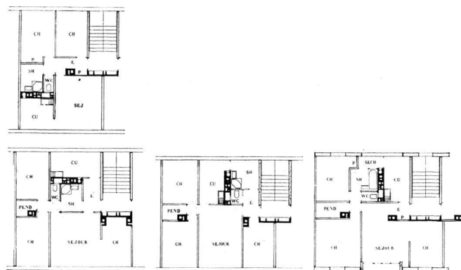
Fig. 4. Types de plans HLM réalisables avec les éléments 1958.
