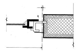
12, 13 Cadre de fenêtre normalisé. Le souci d'être indépendant de la construction adjacente a entraîné un élargissement du cadre.
