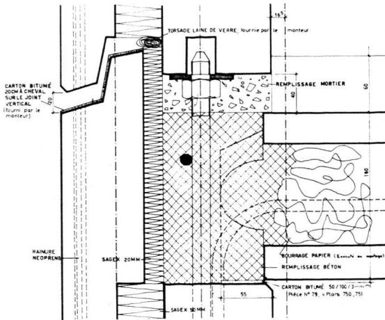
5 Angle entre façade, mur intérieur et mur balcon 1:5.
