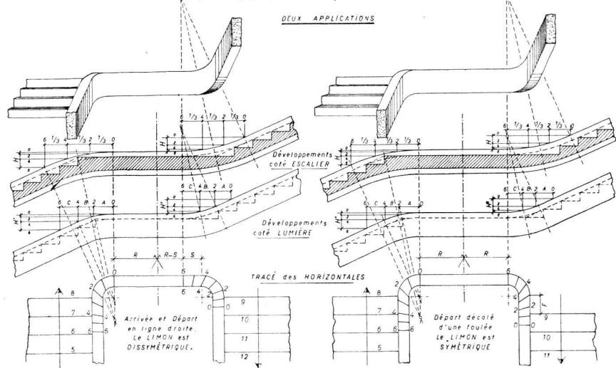
Restant scrupuleusement dans les normes de la géométrie, le balancement hélicoïdal permet une exécution correcte et en même temps grandement facilitée, par les plans, développements et panneaux qu'il nous permet d'établir.
