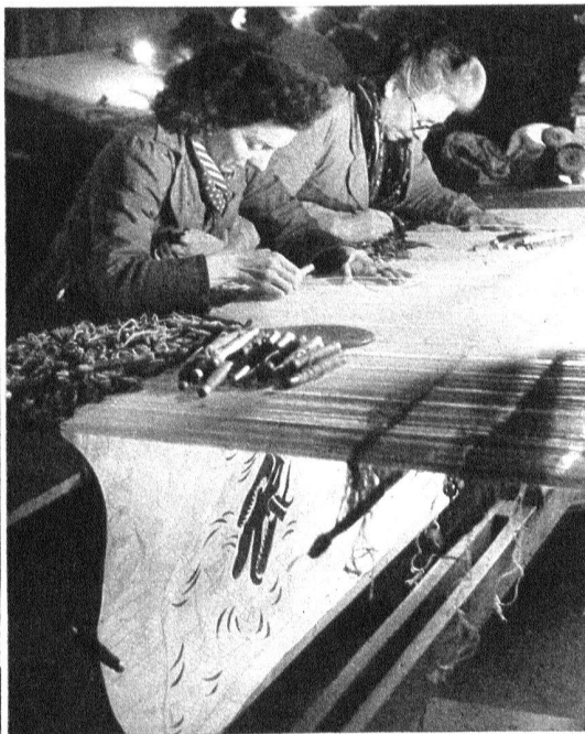
Le carton est glissé sous la chaîne. On le remarque dans la partie inférieure de la photographie.
