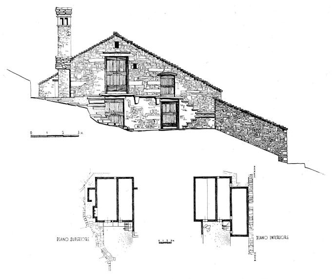
Planche 5 : Dunzio. Cascine, Situation parallèle à la pente du terrain. Murs et toiture de pierres sèches.
