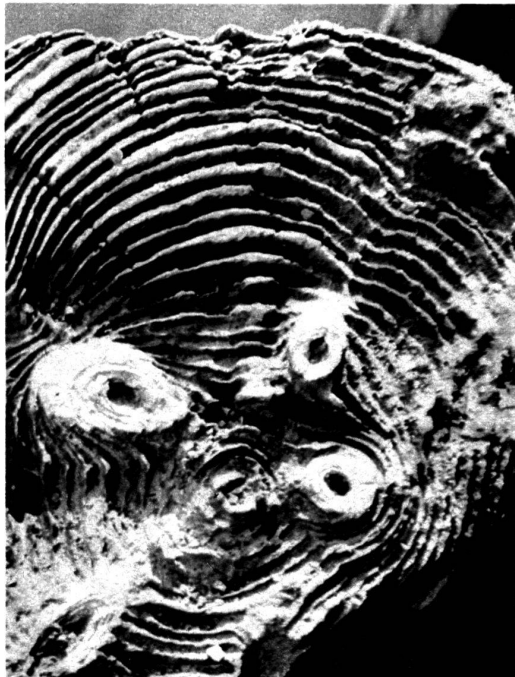
Action du lavage de la pluie sur le bois de bout.
