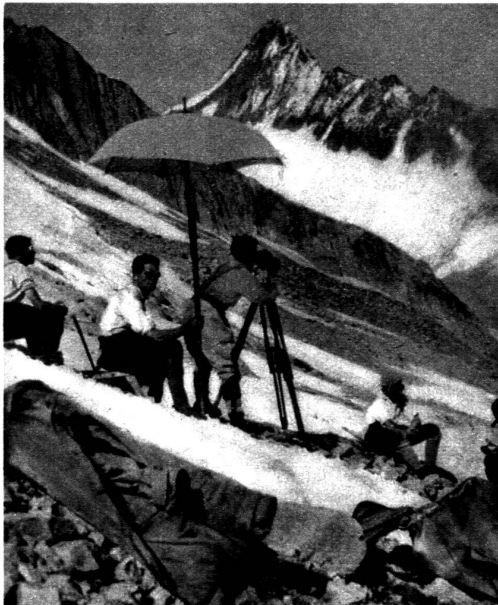
Fig. 9. — Une station photogrammétrique terrestre. Le photothéodolite est en place sur une extrémité d'une base d'environ 300 m. par exemple, exactement mesurée. Les directions des photographies prises sont orientées par rapport à la base et par rapport à l'horizon. La région à lever est ensuite photographiée de l'autre extrémité de la base.
