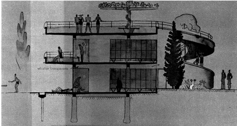
Coupe transversale du bâtiment des cabines. Construction en porte-à-faux exigeant un minimum de fondations et des sections de béton armé très fines.
