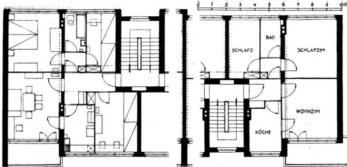
Fig. 7. **Plan des appartements de 3 et 4 pièces.**
