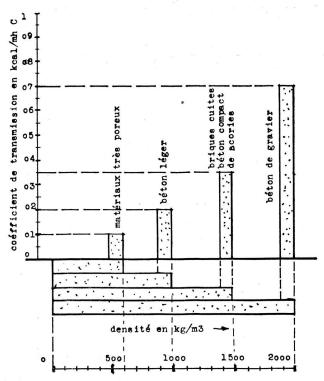
Fig. 2. Rapport entre le coefficient de transmission calorique et la densité des matériaux de construction.
