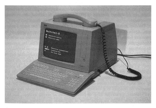
Figure 2: Multitel, terminal loué par les PTT aux abonnés Vidéotex à la fin des années 1980.
