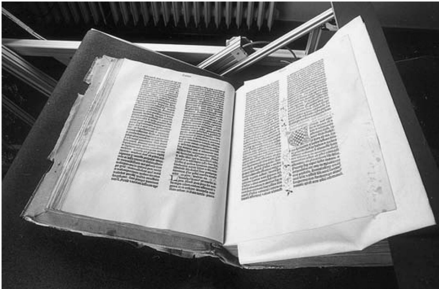
Abb. 3: Die Bibel in der Buchwippe. Eine Pergamentseite liegt auf einer Zellstoff-Gaze; beide werden vom Ansaugarm gehalten.
