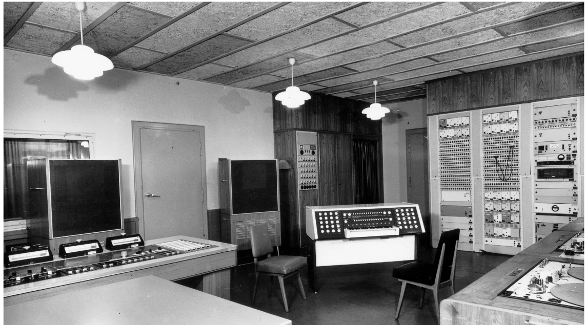
fig.1 Subharchord synthesizer inside the Labor für akustisch-musikalische Grenzprobleme.
