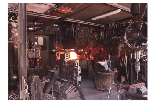
La forge de Charmey, au plafond on voit les courroies de transmission du moteur électrique, <sup>©</sup> Amis de la vieille forge de Charmey
