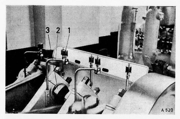
Bild 1 1 Tropföler. 2 Halter. 3 Rotierende Kurbelwelle.
