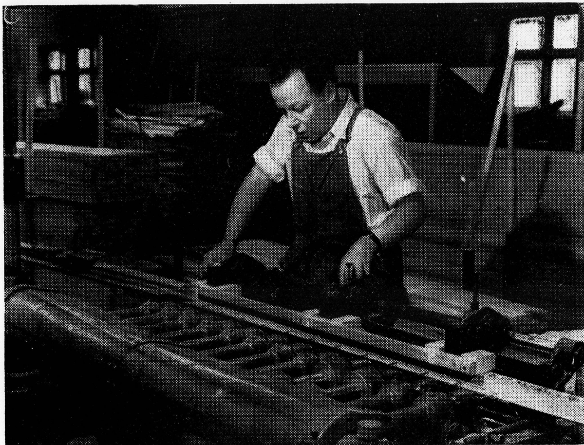
Körperbehinderter bedient Mehrspindel-Bohrmaschine Herstellung von Holzgestellen aus afrikanischem Hartholz
