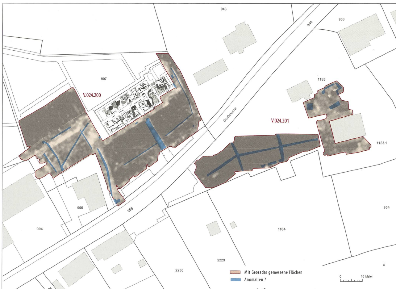
Abb. 26: Windisch-Dorfkirche 2024 (V.024.200) und Windisch-Pfarrgarten 2024 (V.024.201). Vereinfachtes und interpretiertes Gesamtbild des Georadars (Tiefenscheiben ca. 0,5–0,75 m) im Bereich zwischen Dorfkirche und Pfarrgarten. Eingeklinkt ist ein Befundplan mit den römischen Befunden der Grabungen 1964–66 innerhalb der Dorfkirche.
