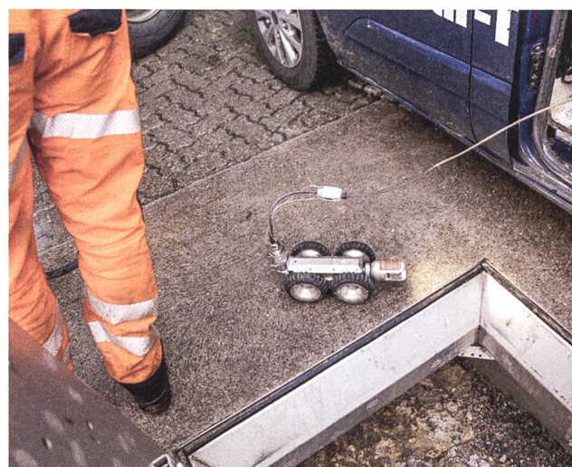
Abb. 15: Windisch-Wagnerhof (V.023.80). Vierrädriger ferngesteuerter Kamerawagen für Kanalfernsehaufnahmen während der Vorbereitung für seinen Einsatz am 17. 11. 2023.
