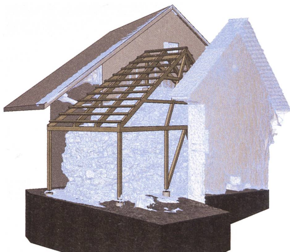
Abb. 8: Brugg-Altenburg (Bru.023.80). Die auf der Grundlage des 3D-Modells erstellte Visualisierung der Schutzdach-Ausführung.
