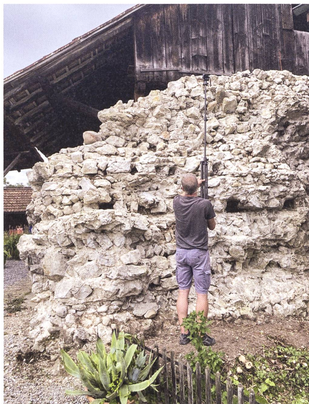
Abb. 7: Brugg-Altenburg (Bru.023.80). Der Fotograf Klaus Powroznik bei der fotogrammetrischen Aufnahme der Kastellmauer.
