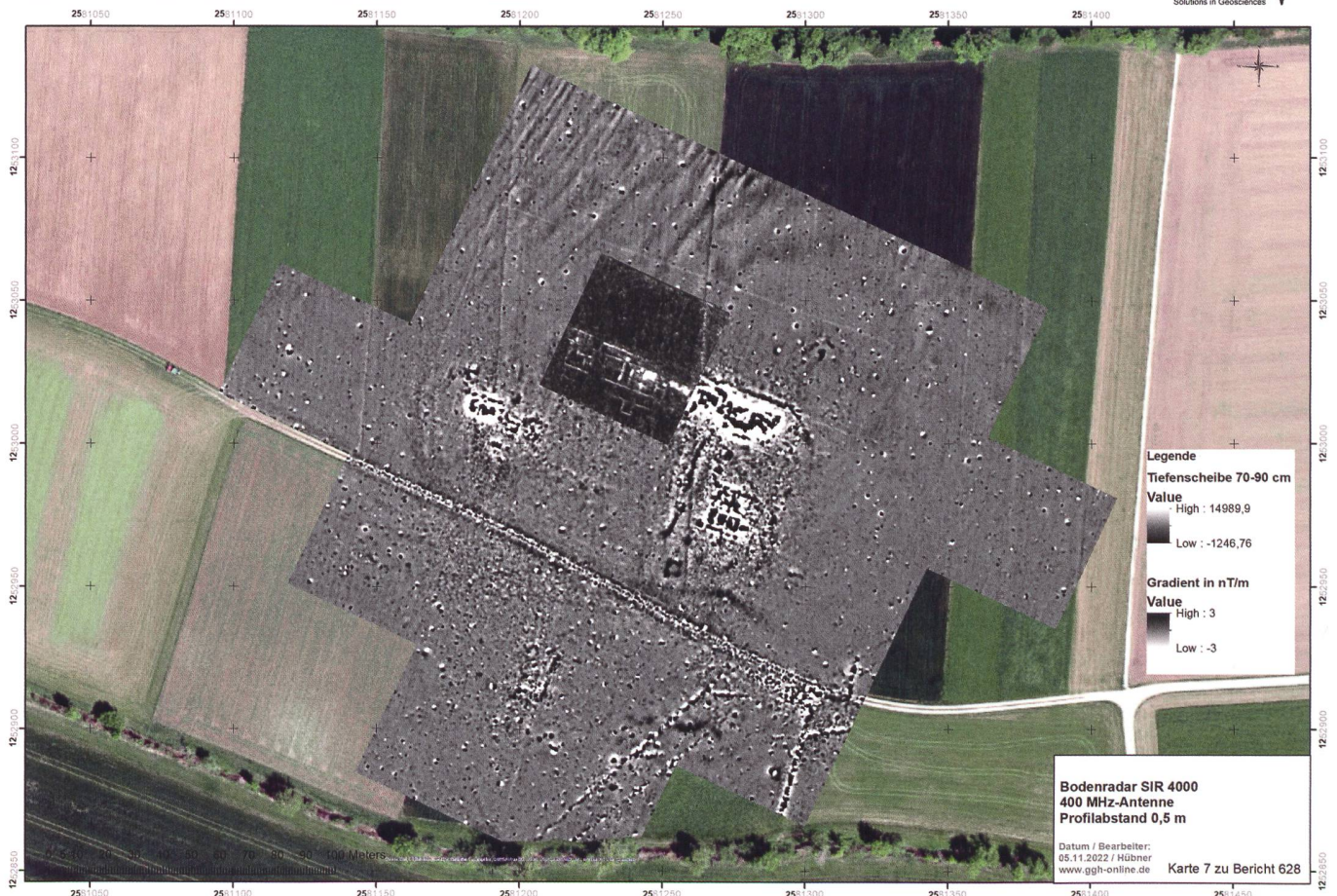
Abb. 12: Charmoille JU, Miserez. Die Überreste der römischen villa rustica zeichnen sich im geophysikalischen Befund sehr deutlich ab (Magnetogramm (Dynamik \pm 7 nT/m).
