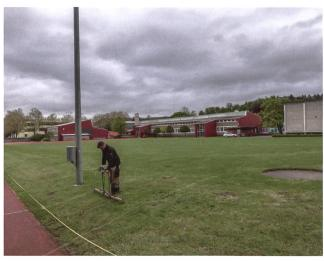
Abb. 17: Windisch-Dohlenzelg 2021 (V.021.9). Arbeitsfoto von Südwesten auf die von M. Nieberle durchgeführten geoelektrischen Messungen im Bereich des heutigen Sportplatzes, dem Standort des geplanten Schulhauses.
