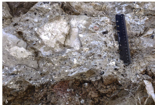
Abb. 6: Mumpf-Sanierung Kantonsstrasse (Mmp.019.2). David Wälchli und Daniel Huber (KAAG) bei der Reinigung des bei Bauarbeiten teilweise zerstörten Fundamentbereichs der spätantiken «Magazinstation» Mumpf-Burg (a). Detailaufnahme des nach wie vor «pickelharten» opus caementitium im Bereich der teilweise zerstörten Fundamentpartie (b). Gut zu erkennen sind die weissen Kalkspatzen (Klümpchen aus gelöschtem Kalk). Kalkspatzen wirken wie kleine Speicher, aus denen sich Calciumhydroxid lösen und an anderer Stelle kristallisieren kann. So können kleine Risse «verheilen» und der Mörtel erhält mehr Festigkeit.
