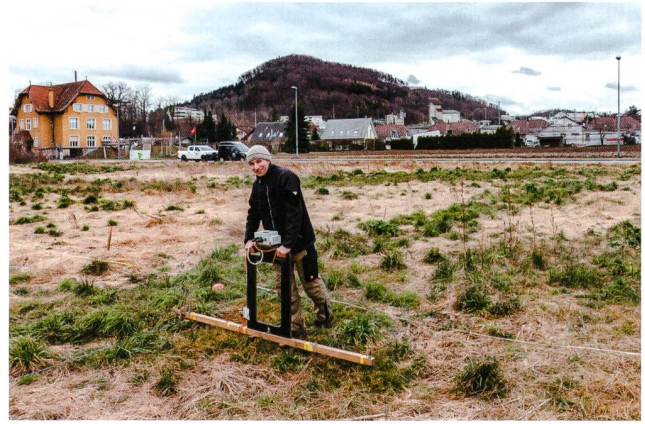
Abb. 28: Gebenstorf-Schulstrasse 2018 (Geb.018.2). Blick von Nordwesten auf die geophysikalisch vermessene Fläche vor der Arealüberbauung. Manuel Buess bei der geoelektrischen Prospektion. Im Hintergrund das Gebenstorfer Horn.
