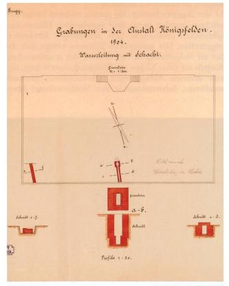
Abb. 14: Windisch-Königsfelden 1904 (V.04.3). Zeitgenössischer Plan mit Lage, Aufsicht und Schnitt eines gemauerten Kanals samt Einstiegsschacht nordöstlich des Klinikhauptgebäudes von Königsfelden.
