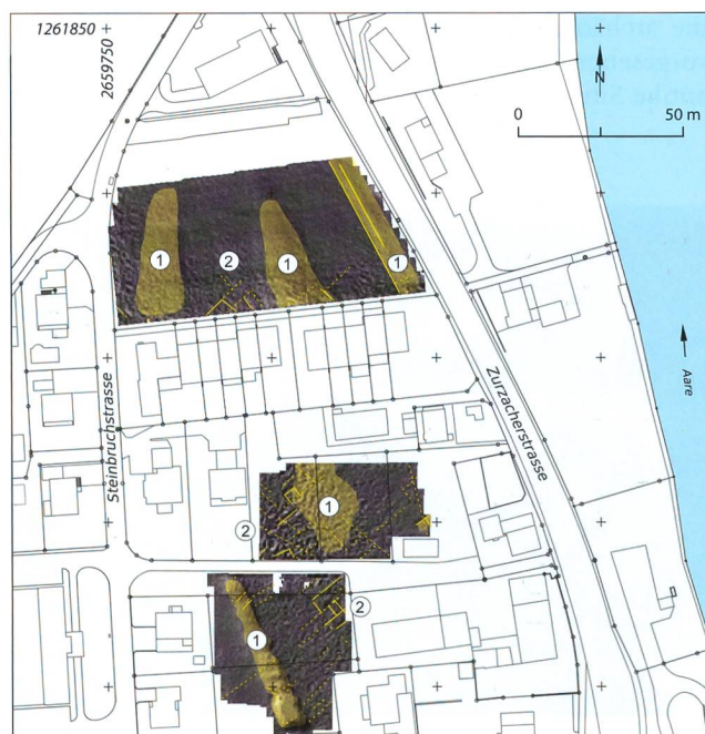
Abb. 30: Brugg-Lauffohr 2017 (Bru.017.1). Gesamtplan der geoelektrisch prospektierten Flächen mit Interpretation der festgestellten Anomalien.
