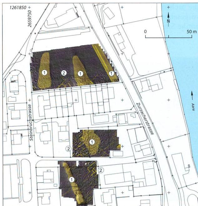
1 Strukturen geologisch? 2 Strukturen anthropogen? Abb. 30: Brugg-Lauffohr 2017 (Bru.017.1). Gesamtplan der geoelektrisch prospektierten Flächen mit Interpretation der festgestellten Anomalien.
