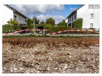
Abb. 16: Windisch-Dägerli (Sternmatte) 2015 (V.015.3). Blick von Süden auf das Profil am nördlichen Baugrubenrand. Unter der hier nur dünnen Humusdecke liegt eine Abfolge von kiesigem Lehm zu unverwittertem Kies mit unruhig verlaufender Schichtengrenze. Hierbei handelt es sich nicht um anthropogene Befunde (Gruben o.ä.), sondern um geologische Phänomene (Kryoturbation).
