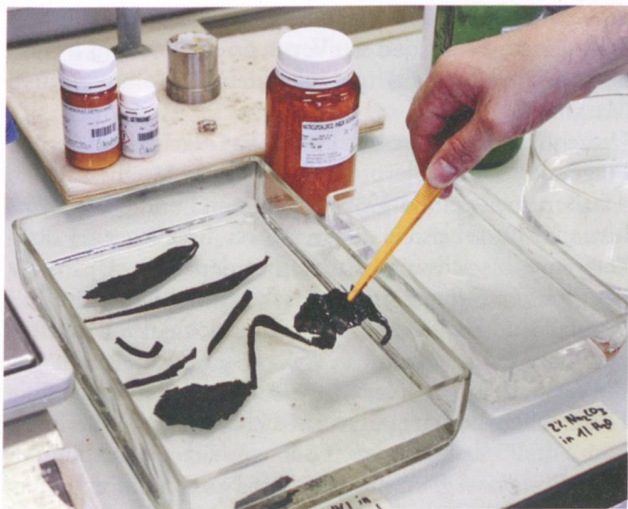
Abb. 22: Die Proben werden ins Salzsäurebad gegeben.
