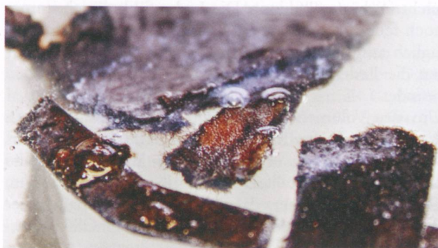
Abb. 23: Beim zweiten Eintauchen ins Natriumcarbonat-Bad bilden sich intensiv Blasen.
