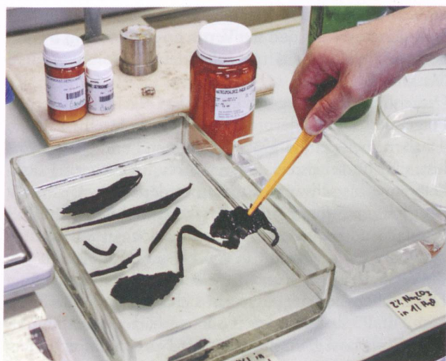
Abb. 22: Die Proben werden ins Salzsäurebad gegeben.
