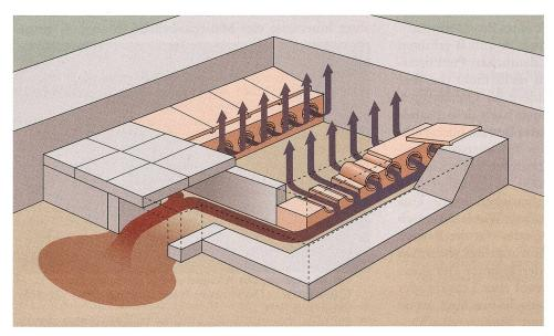
Abb. 23: Funktionsschema des Räucherofens.
