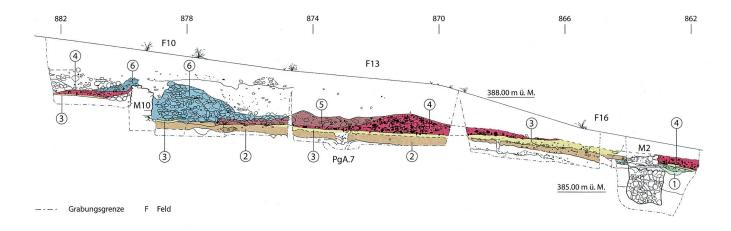
Abb. 16: Kirchdorf, Gebäude A: Ostprofil. 1 Bauhorizont, 2 Lehmboden, 3 Benutzungshorizont, 4 Dachversturz, 5 Planieschicht, 6 Mauerversturz.
