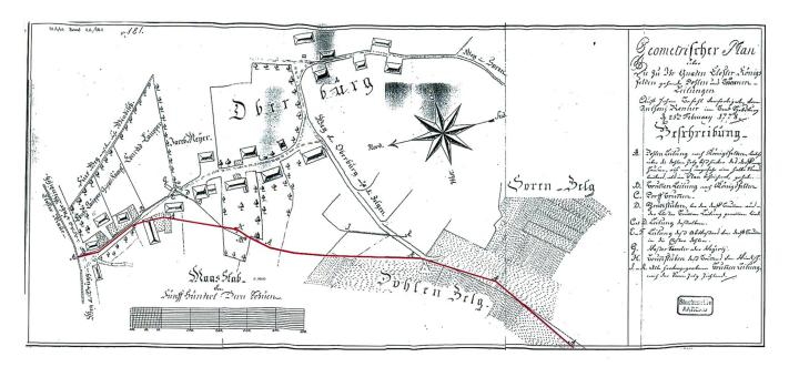
Abb. 6: Aus dem Staatsarchiv Aargau, jetzt auch digital verfügbar: Plan aus dem Jahr 1778 mit römischen und frühneuzeitlichen Wasserleitungen in Windisch-Oberburg. Es handelt sich um die derzeit älteste bekannte planerische Darstellung der laufenden römischen Wasserleitung von Vindonissa (hier zusätzlich rot markiert).
