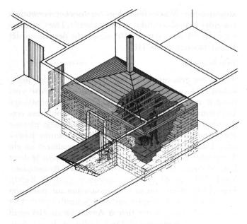
Abb. 20: Kastell Oberstimm. Rekonstruktion der Räucherkammer aus der fabrica (nach: Schönberger 1978, Abb. 19).
