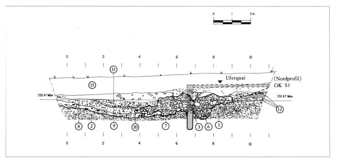
Abb. 5: Windisch-Spitzmatt. Westprofil mit Schnitt durch die rekonstruierte Uferbefestigung und Verlauf der älteren Uferböschung auf natürlich anstehendem Flusskies S1 mit römischen Funden vermischtem Flusssediment S2 (grau, Zeichnung C. Wesp).
