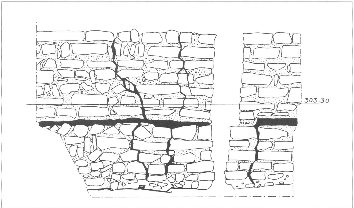
Abb. 3: Sulz, Rheinsulz. Südostecke der Turmaussenseite. M. 1:25. Zeichnung D. Wälchli, Aargauische Kantonsarchäologie.
