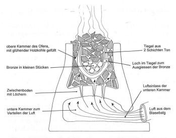
Abb. 4. Längsschnitt durch den rekonstruierten Giesserofen im Betrieb. Angenommene Höhe 19 cm. Zeichnung M. Trachsel
