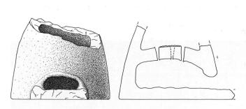
Abb. 2. Zeichnung des Giesserofens in der Ansicht und im Längsschnitt. Erhaltene Höhe 13,5 cm. Zeichnung M. Trachsel
