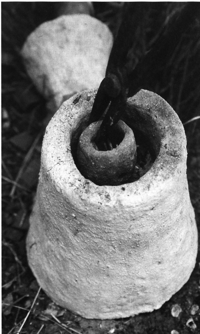
Abb. 5. Versuchsbetrieb. Ein Tiegel wird in den Ofen gesetzt. Zwischen Tiegel und Ofenwand bleibt nur wenig Platz. Foto Experiment A.
