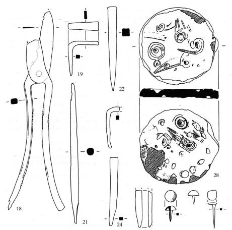
Abb.2 Werkzeuge eines Blechschmiedes aus Oberwinterthur: 18 Blechschere, 19 Amboss oder Amboss-Einsatz, 21 Rundfeile?, 22 Durchschlag, 24 Durchschlag?, 28 Punzkissen. M 1:3 (nach Rychener 1988, Taf. 25).
