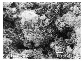
Abb. 4: Mögliche C-S-H-Kristalle von etwa  $\frac{1}{1000}$  mm Länge (=1  $\mu$ m).
