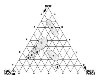
Abb. 1: Rankine-Diagramm für verschiedene Bindemittel, nach Krenkler, 1980, mit Ergänzungen aus Jäckli, 1989. a: Puzzolane, Trass, b: Hochofenschlacke, c: Hochofenzement, d: Eisenportlandzement, e: Portlandzement, f: Tonerdezement, g: Kalk, h: Zürcher Ziegeleitone, \*: Bindemasse von hydraulischem Kalk.
