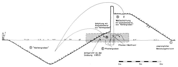
Abb. 4: Schematische Darstellung des Bauvorgangs
